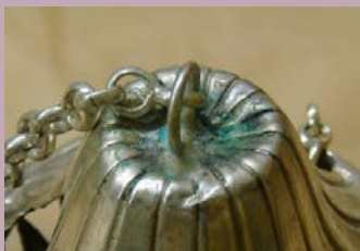
PRESENZA DI PATINE DI CORROSIONE (19 a-b)
