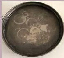
PATINE DI CORROSIONE (15 a-b)
