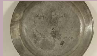
PATINE DI CORROSIONE (15 a-b)
